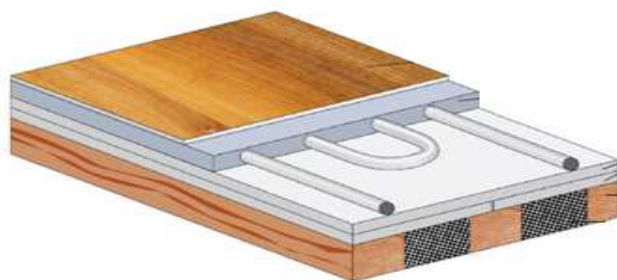
Рис. 1. Загальний вигляд радіаційної панелі
