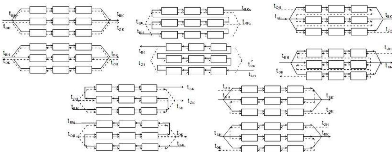
Рисунок 1 – Схемы соединения теплообменных аппаратов в теплообменники
