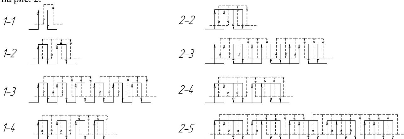
Рисунок 2 – Схемы тока сред в аппаратах
