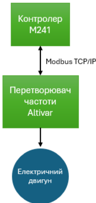
Рисунок 2 – Схема керування потоком з використанням перетворювач частоти Altivar
