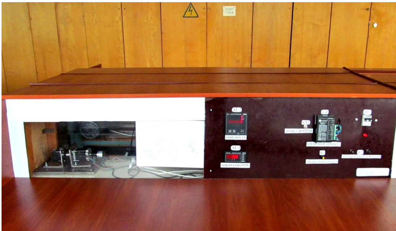
Рисунок 6 – Фізична реалізація дослідницького стенду для дослідження характеристик крокових двигунів. Загальний вигляд
