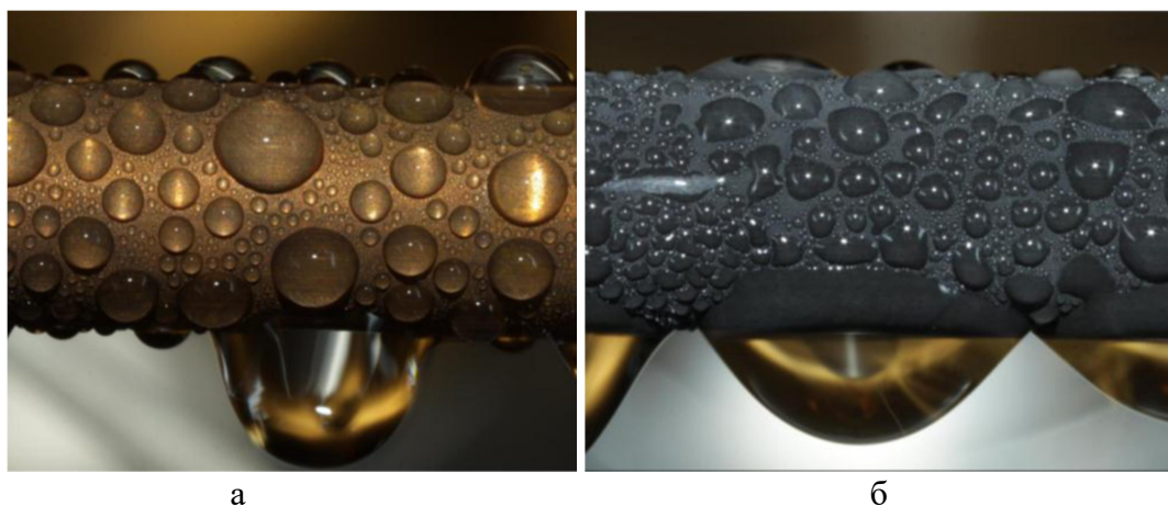
Рисунок 1 – Процес краплинної конденсації на поверхні мідної горизонтальної трубки, обробленої Нанопротеком: а – свіжо нанесене покриття, б – через рік роботи.
