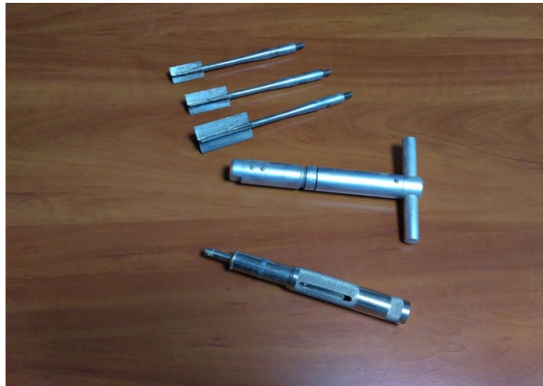
Рис. 1. Інструменти для польових випробувань для отримання характеристик глинистих ґрунтів (кишеньковий пенетрометр та крильчатка)
