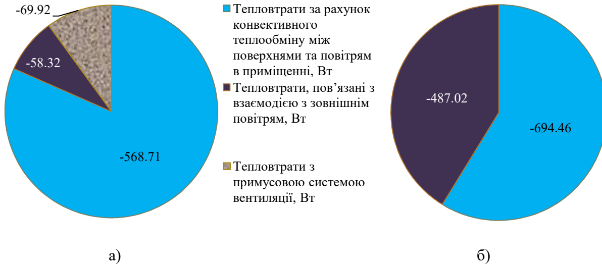
Рисунок 6 – Тепловий баланс тепловтрат для зони 4 (а) та для зони 5 (б)
